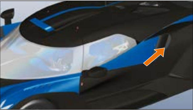
ABB.91 ICE-LÜFTER SEITLICH RECHTS UND LINKS
